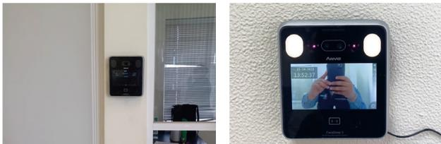
FaceDeep 3 es el nuevo terminal de reconocimiento facial basado en IA equipado con una CPU de doble núcleo basada en Linux y el algoritmo de aprendizaje profundo **BioNANO®**. Admite hasta 6,000 caras dinámicas y reconoce rápidamente a los usuarios dentro de 2 m en menos de 0,3 segundos y personaliza las alertas y una variedad de informes incluso el del uso de cubrebocas.
